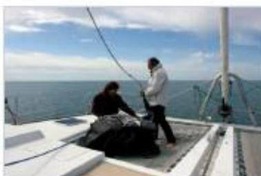
Les deux écoutes sur chaque bord sont prêtes. La drisse est frappée sur le spi et sa chaussette
