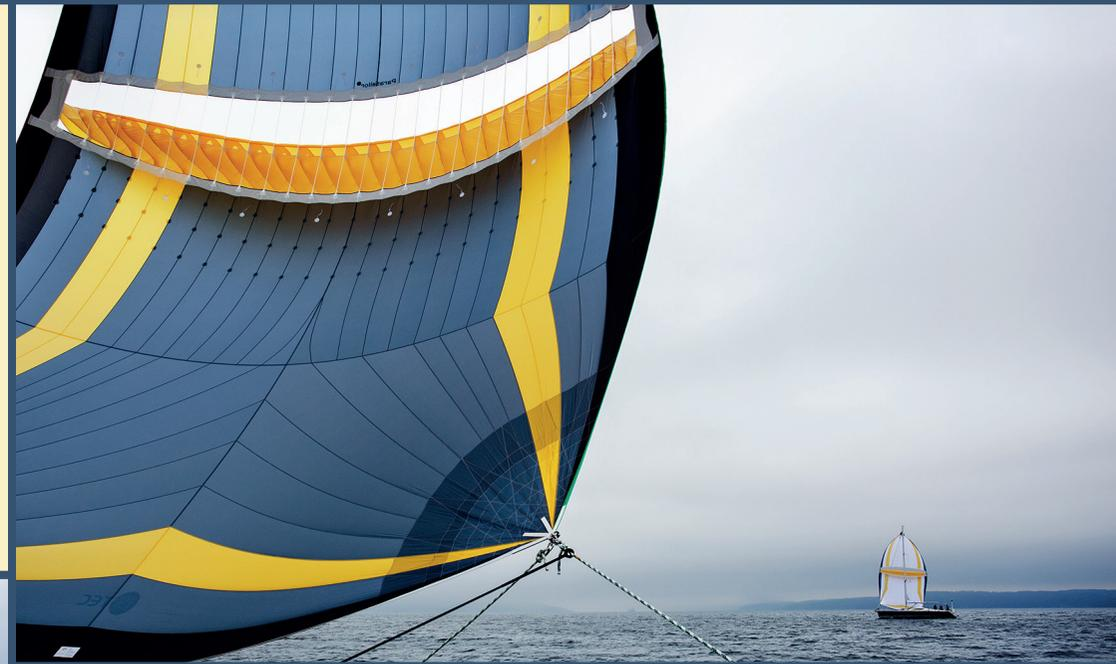
Dans le Parasailor, le flux est canalisée et, s'écoulant par la prise d'air située au milieu de la voile est dirigé vers l'aile pour l'alimenter d'une ventilation puissante et maîtrisée qui permet d'associer un second phénomène de force active, la portance, donc une composante vient s'ajouter à la poussée.
