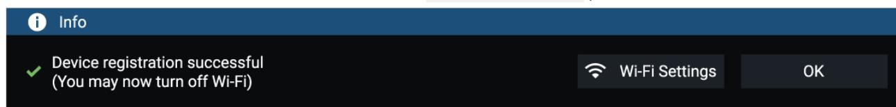
Une fois l'enregistrement terminé, vous pouvez éventuellement désactiver votre connexion Wi-Fi en sélectionnant **Paramètres Wi-Fi** et en désactivant le Wi-Fi de votre MFD. Sélectionner **OK** aura pour effet de fermer la boîte d'information tout en laissant la connexion Wi-Fi activée.
