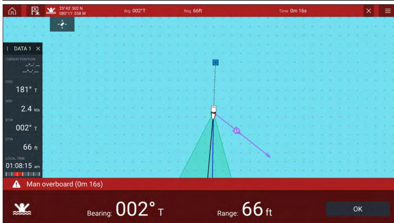
Pour utiliser la fonction MOB, votre navire doit avoir un relevé de position valide provenant d'un récepteur GNSS (GPS). Le mode Estime a également besoin des données de cap et de vitesse.
